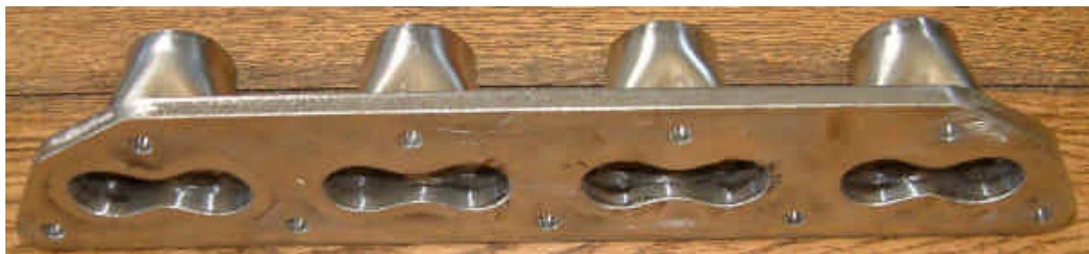
Il « suffit » de percer au diamètre de 5 selon les croix. Ensuite c'est avec une lime et un peu de temps que l'on termine le travail.
